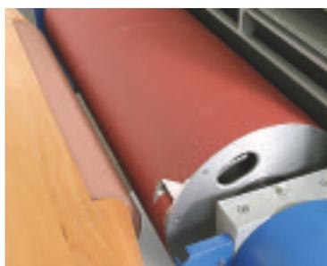
La carta abrasiva, avvolta a spirale sul cilindro, si fissa con un semplice sistema a pinza con tensione automatica della carta stessa.
